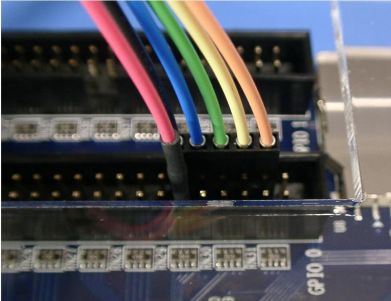
ポケットロジアナとお客様開発の基板上的 FPGA との接続は、次ページのように信号 4 本と GND 2 本、VCCIO 1 本を接続します。FPGA 側は、任意のユーザー I/O ピンを使えます。使用する FPGA の I/O ピンは、FPGA 基板からポケットロジアナへ供給する VCCIO の電圧レベルに合わせてください。FPGA の入力信号 IP\_WR, IP\_RESET, IP\_CMD は、FPGA 内蔵の Weak Pull-Up 抵抗で Pull-Up します。
