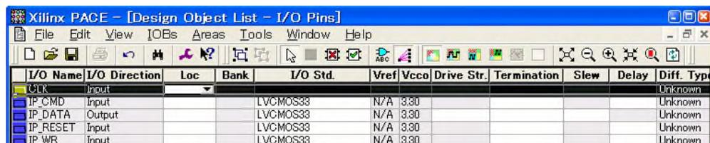
ポケットロジアナと接続する信号の I/O Std.を LVCMOS33 または LVCMOS25 に設定します。ポケットロジアナとの接続には、入出力レベルが 3.3V または 2.5V の I/O ピンを使用してください。
