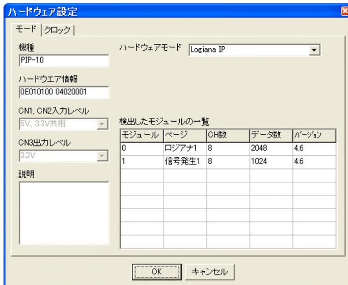
ロジアナ IP に供給するクロックが 50MHz 以外の方は、同じダイアログで、「クロック」タブをクリックし、IP クロック周期を整数で記入してください。
