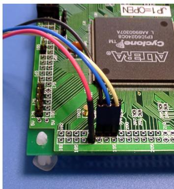
FPGA 基板上にピンヘッダ(4pin、または 3pin と 1pin)を立てます。
